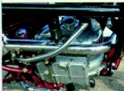
Unten ohne: Der Beiwagenrahmen schließt den unten offenen Rahmen der Enfield.
