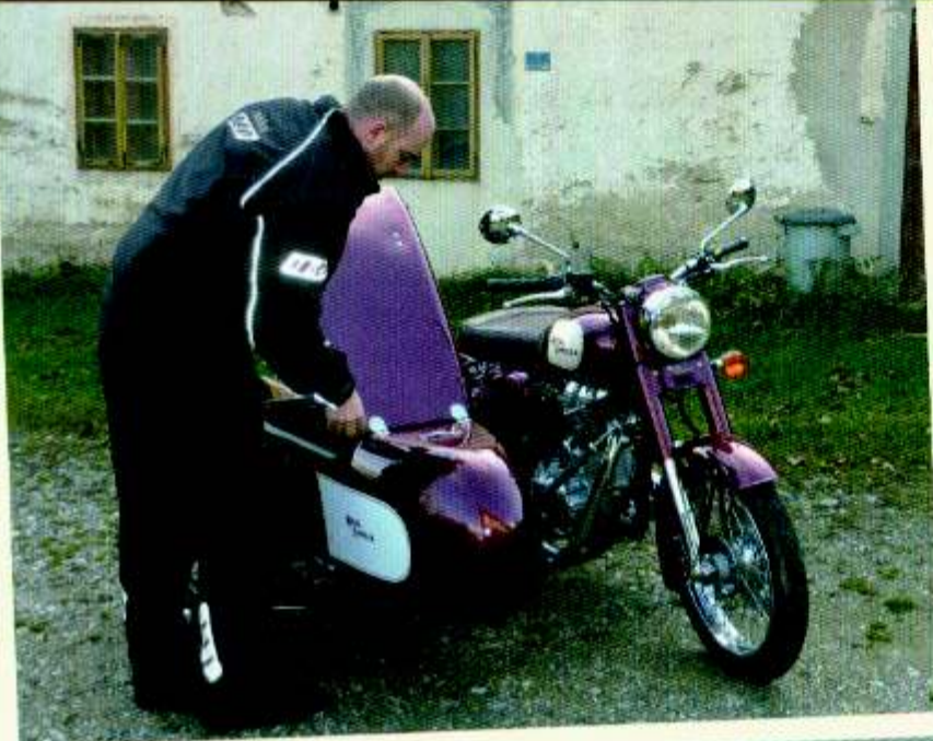
Die Umrüstung von Personen- auf Lastenbeiwagen dauert nur Sekunden. Scheibe und Klappe sind mit Dauersplintn fixiert. Die beiden Schrauben des Sitzes, eine Sonderausstattung, sind schnell gelöst.
