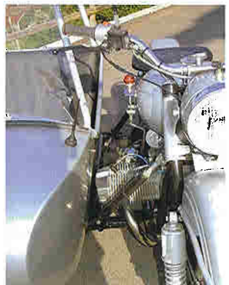
Der Rahmen wurde um nur 190 Millimeter verbreitert, das Boot jedoch um 240 Millimeter im Frontbereich. Hier ist deutlich zu sehen, dass jeder Millimeter am Fahrgestell ausgenutzt wurde.
